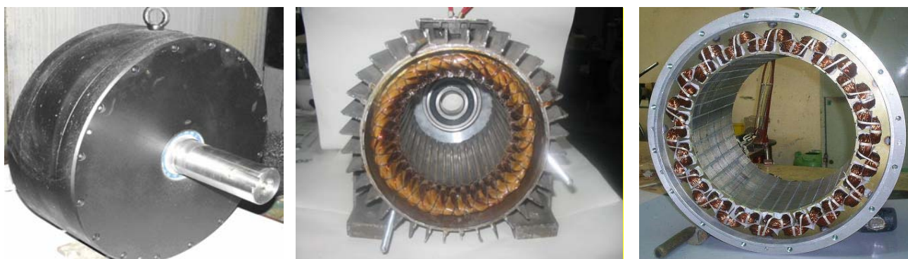
Figura 1. Generatoare sincrone lente, cu antrenare directă, cu magneți permanenți, fabricate în ICPE-ME. Stânga, 12 kW/170 rpm (diametru exterior tola stator 430 mm). Mijloc, stator generator de 3 kW/550 rpm (diametru exterior 212 mm). Dreapta, vedere bobinaj fracționat concentrat pe dinte, mașina de 12 kW/170 rpm.
